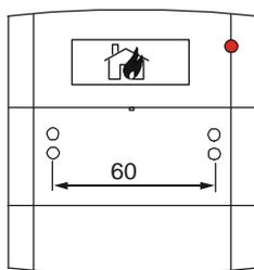
Расстояние между монтажными отверстиями 60мм
